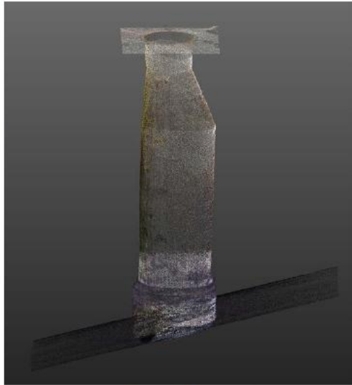
4m tiefer, gemauerter Schachtboden mit Betonringen und Konus
